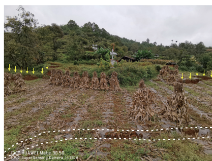
(b) 滑坡后缘下错陡坎
