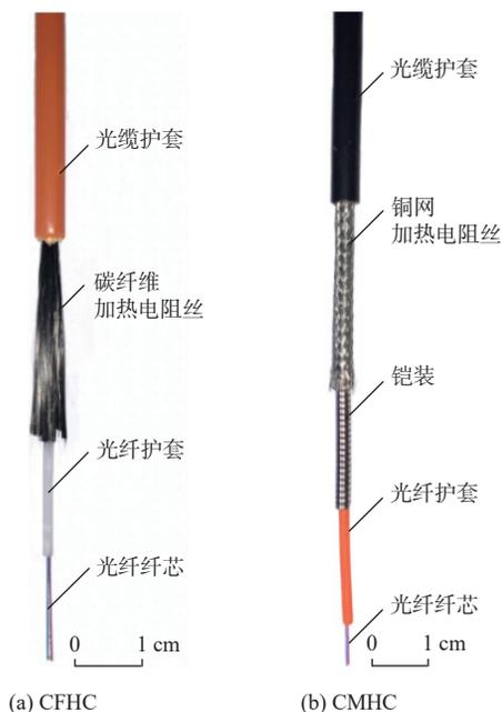
图 2 CFHC 与 CMHC 光缆结构图
