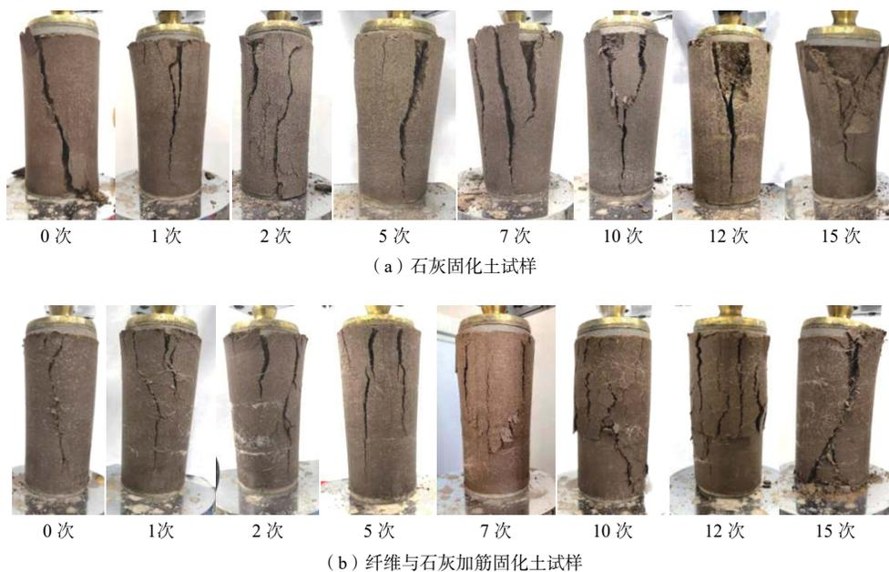
图 5 不同冻融次数石灰固化土和纤维与石灰加筋固化土试样的抗压破坏形态
