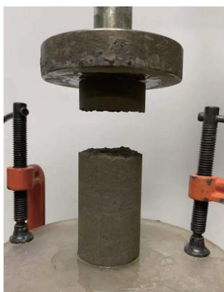
图 8 水泥改良土的拉伸破坏形式
