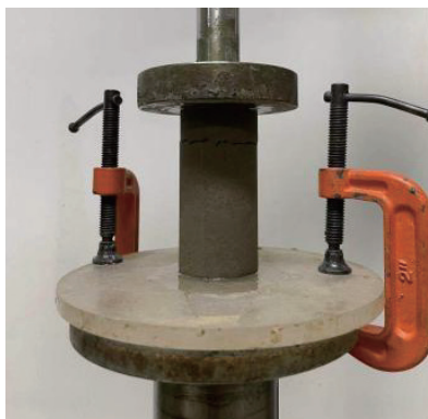
图 6 土样与顶、底座间的固定方法
