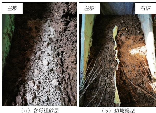
图 7 边坡模型填筑
