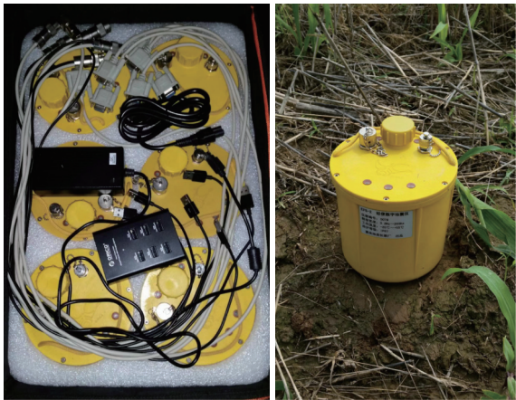
图 2 EPS 便携式数字地震仪 Fig. 2 EPS portable digital seismograph
