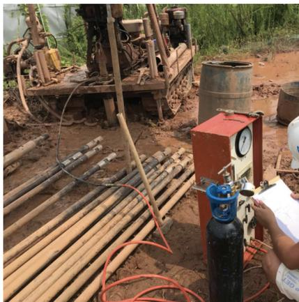
图 4 旁压试验过程照片
