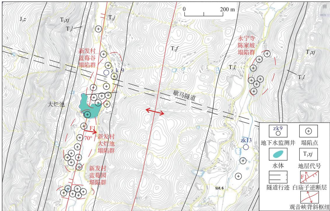
图 2 中梁镇新发村岩溶塌陷展布图
