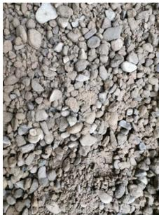
图 7 圆砾卵石⑤层现场开挖照片
