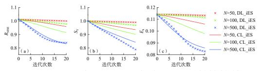
图 2 由 DL\_iES 和 CL\_iES 在 N=50, 100, 500 时得到的  $R_{MSE}$ 、 $S_Y$  和  $E_h$  随迭代次数变化的曲线
