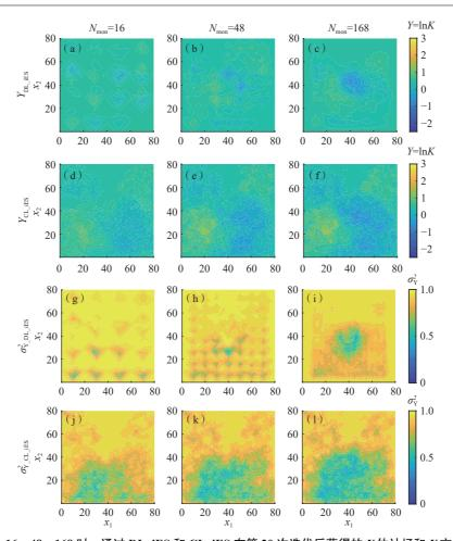
图 4 在  $N_{\text{mon}}$  = 16, 48, 168 时,通过 DL\_iES 和 CL\_iES 在第 20 次迭代后获得的 Y估计场和 Y方差  $(\sigma_{\text{Y}}^2)$  估计场 Fig. 4 Maps of Y fields and Y variance  $(\sigma_{\text{Y}}^2)$  estimated through DL\_iES and CL\_iES at the 20th iteration when  $N_{\text{mon}}$  = 16, 48, 168
