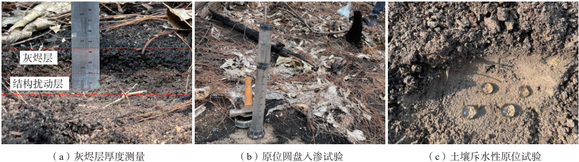
图 3 火烧迹地灰烬层厚度、土壤渗透性及斥水性强度测定
