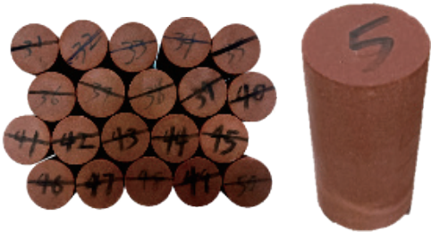
图 1 标准砂岩试样(部分)
