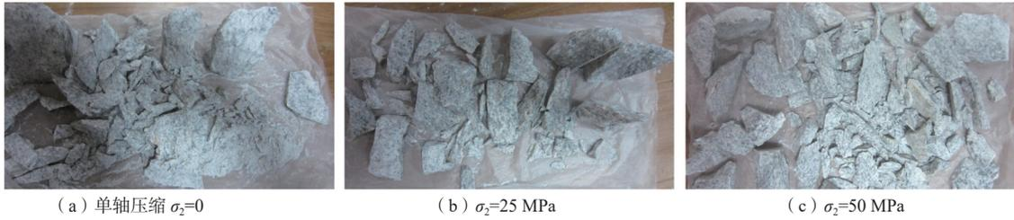
图 6 不同  $\sigma_2$  下花岗岩加载破坏照片
