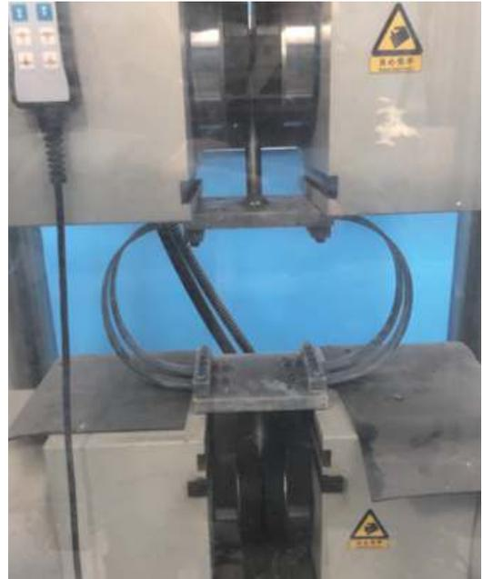
图 7 反复拉压循环试验
