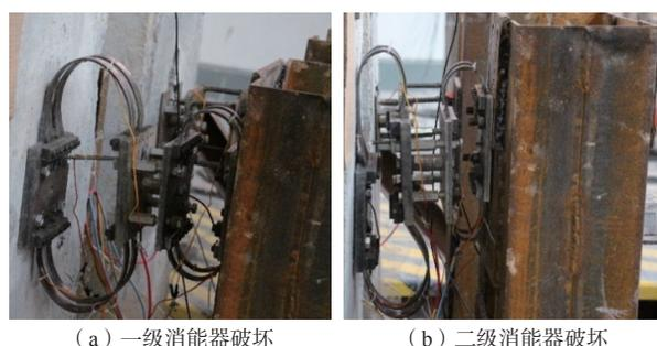
图 12 消能构件破坏图
