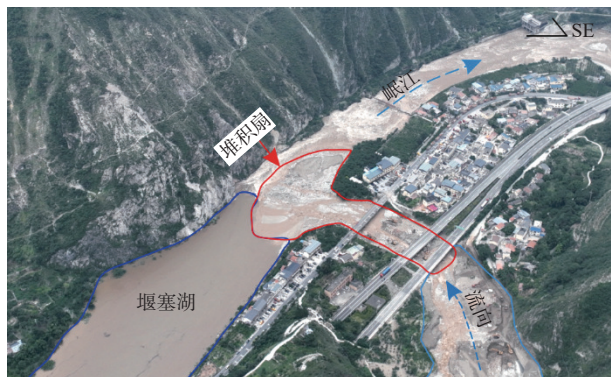
图 1 板子沟泥石流堆积扇 (拍摄于 2023 年 6 月 27 日)
