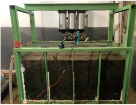
图 2 预压静置后的模型地基
