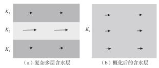
图 4 复杂多层含水层渗透系数及其概化后的平均渗透系数
