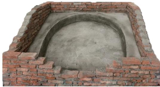
图 5 沟谷模型沟底砌筑成型
