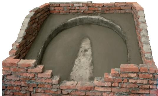
图 6 沟谷模型坡面砌筑成型
