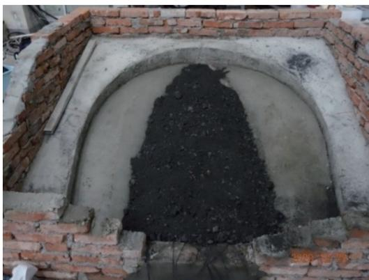
图 8 堆填完毕的煤矸石堆
