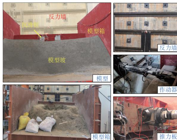
图 4 试验模型及加载装置
