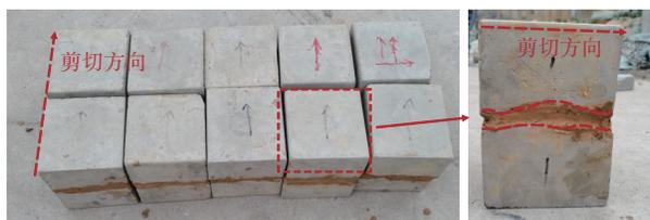
图 6 制备完成的试件
