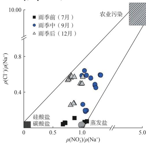
图 8 研究区河水中  $\rho(\text{NO}_3^-)/\rho(\text{Na}^+)$  和  $\rho(\text{Cl}^-)/\rho(\text{Na}^+)$  比值关系
