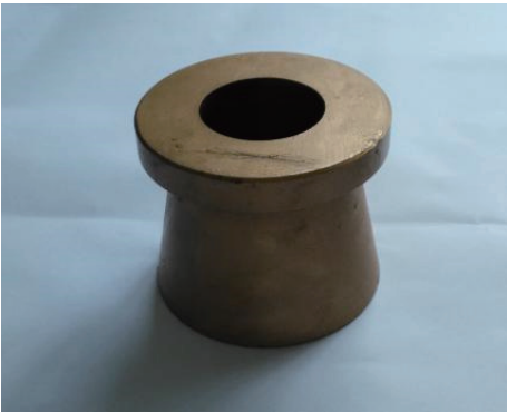
图 1 水泥净浆流动度试模 Fig. 1 Flow test mold of cement paste
