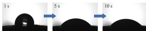
图 3 复合凝胶的动态接触角
