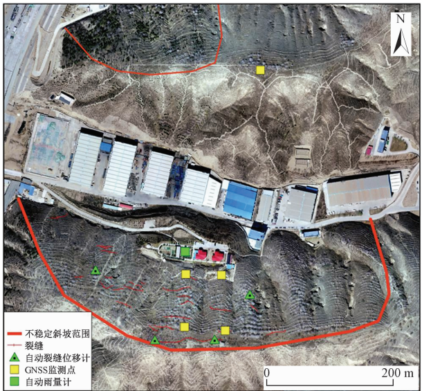
图 7 普兰太公司滑坡应急监测平面布置图
