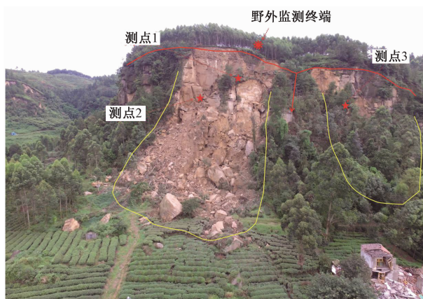
图1 一匹山崩塌后传感器分布图
