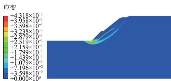
图8 地下水渗流工况塑性应变等值云图
