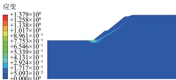
图 17 方案 2 塑性应变等值线图 (1 : 1.25)
