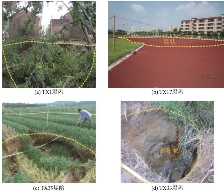
图 2 塌陷坑剖面形态特征示例
