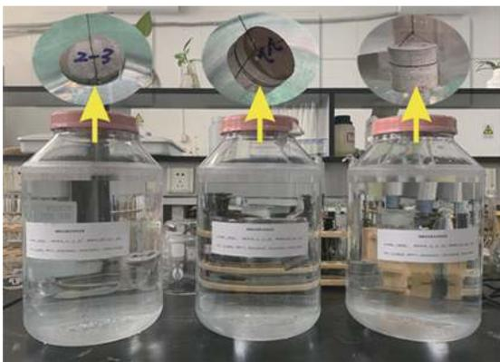
图 3 静态溶蚀试验装置
