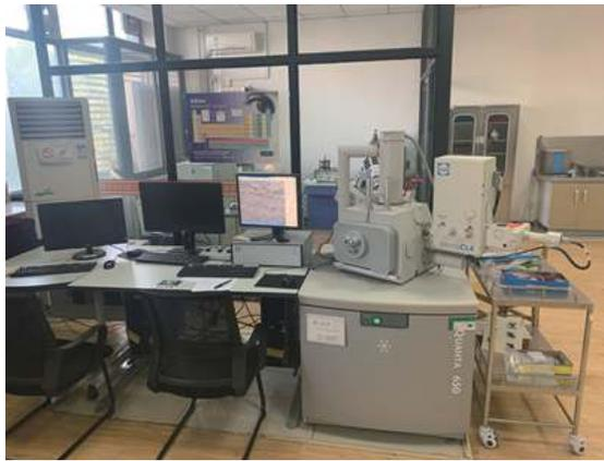
图 10 Quanta 650 型环境扫描电子显微镜
