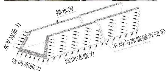
图 6 排水沟冻胀破坏示意图
