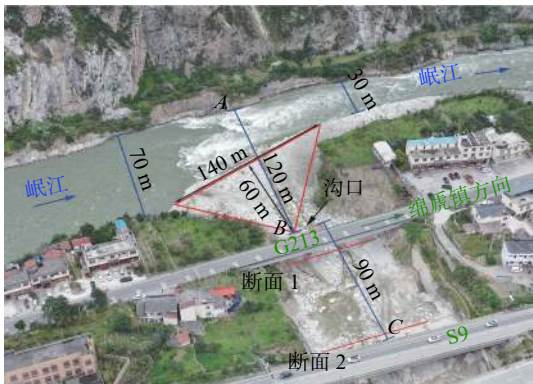
图 5 “8·20”泥石流后板子沟堆积区形态及主要参数
