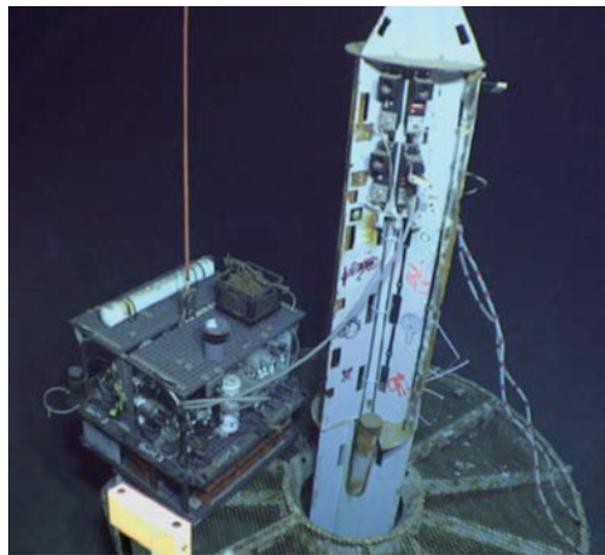
图 8 CORK-II 海底长期钻孔监测技术装备
