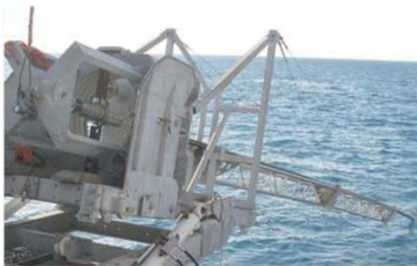
(a) SAAF-Tiltmeter倾角计甲板布放装置
