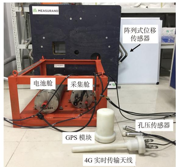
图 6 中国海洋大学海底变形滑动原位实时自动观测装备<sup>[46]</sup>
