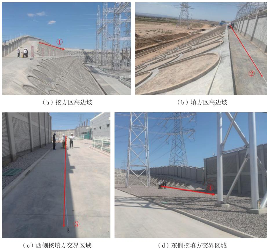
图2 探地雷达测线布置
