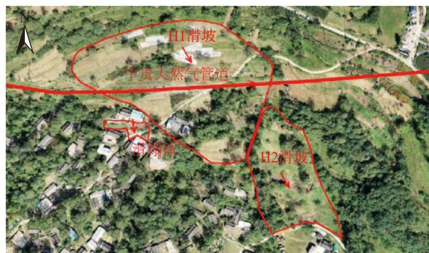
图 1 管道滑坡区域现场地貌图
