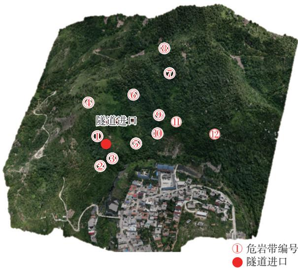
图 1 杏花峪隧道进口三维实景模型
