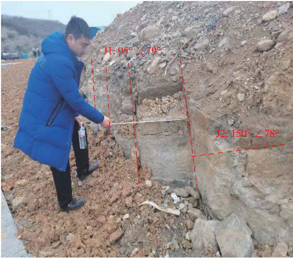
图 2 田湾子滑坡后缘节理
