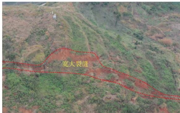
图4 坡顶宽大裂缝
