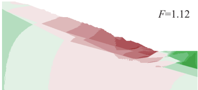
(b) 南帮边坡回填至-50 m 位移图
