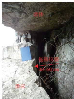
图 8 前缘滑床拖移现象
