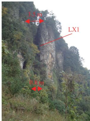
图 5 尾部张拉裂缝
