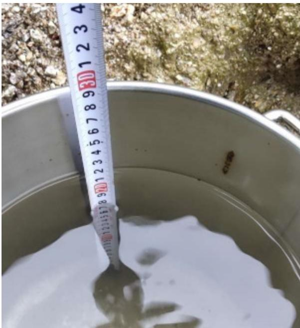
图 2 量测 25 cm 集水器集水深度
