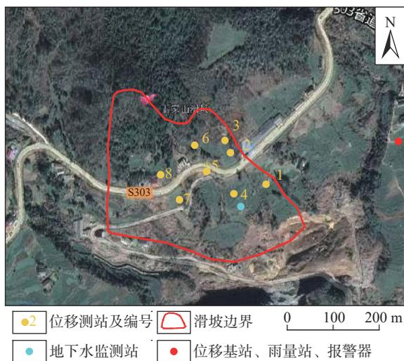
图6 滑坡监测系统布置
