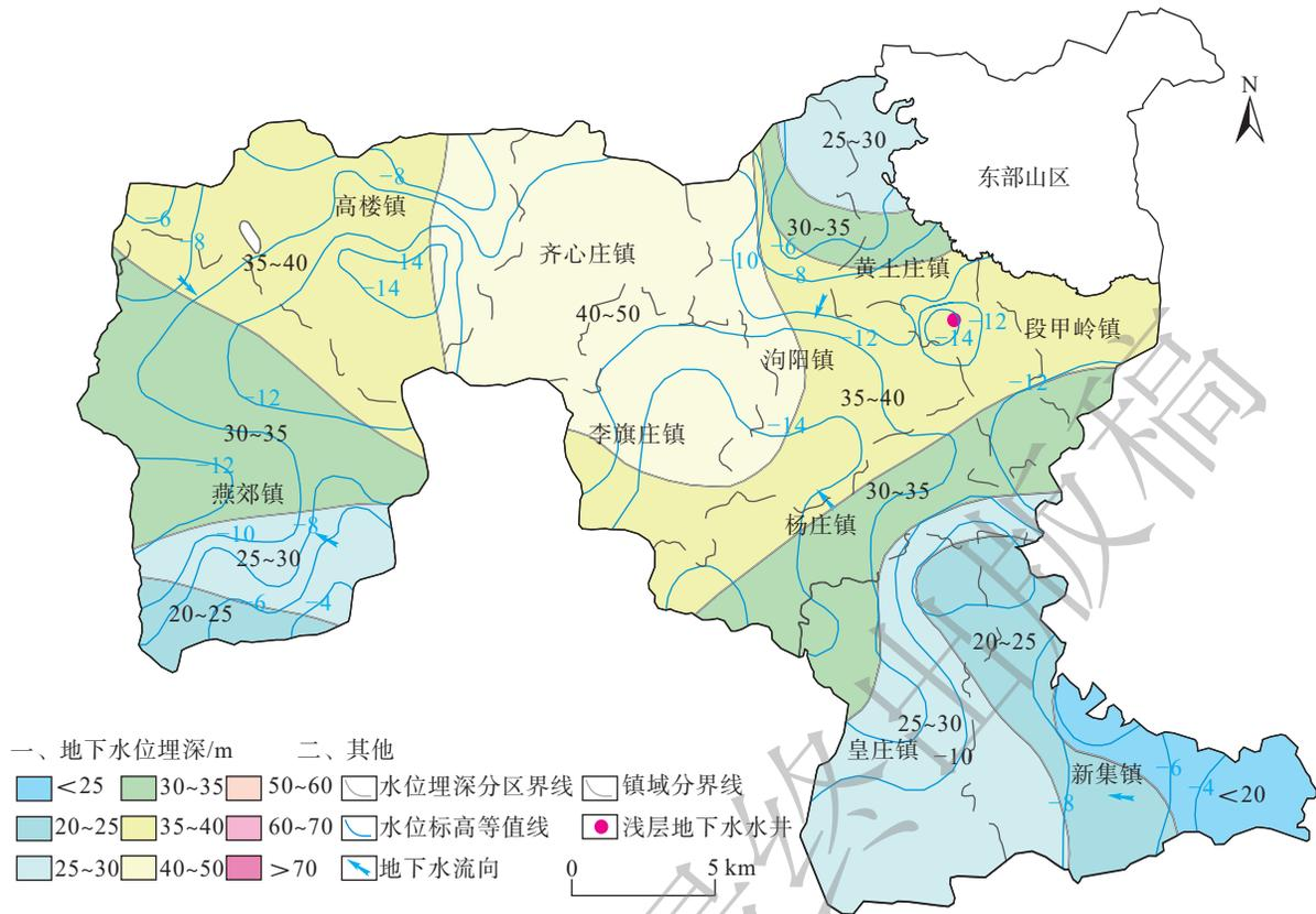
图 5 2020 年 8 月三河市浅层含水层地下水水位等值线和水位埋深图
