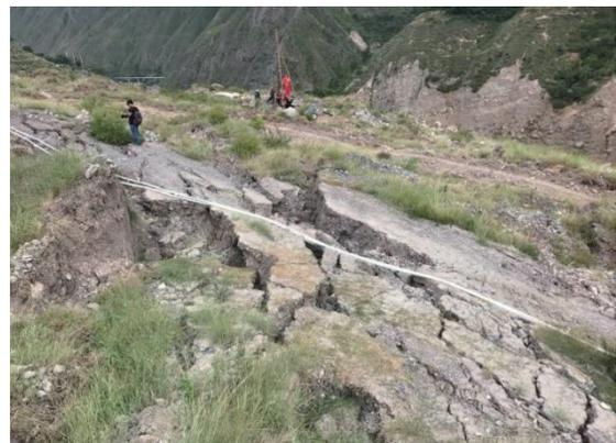
图 2 滑坡中前部剪切裂缝发育图(镜向 SE 170°)
