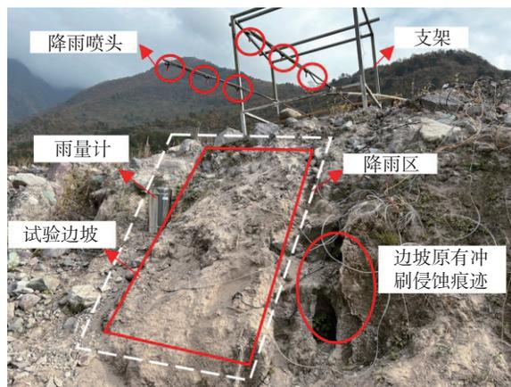
图 3 现场降雨试验装置
