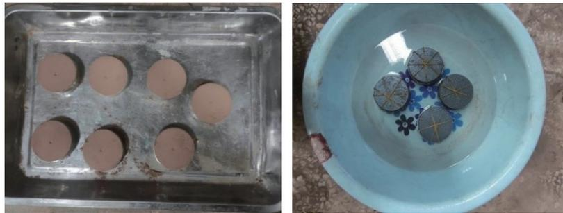
图 4 加固土试样及浸水过程
