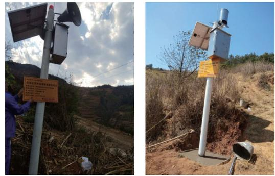
图 6 滑坡隐患点监测预警设备
