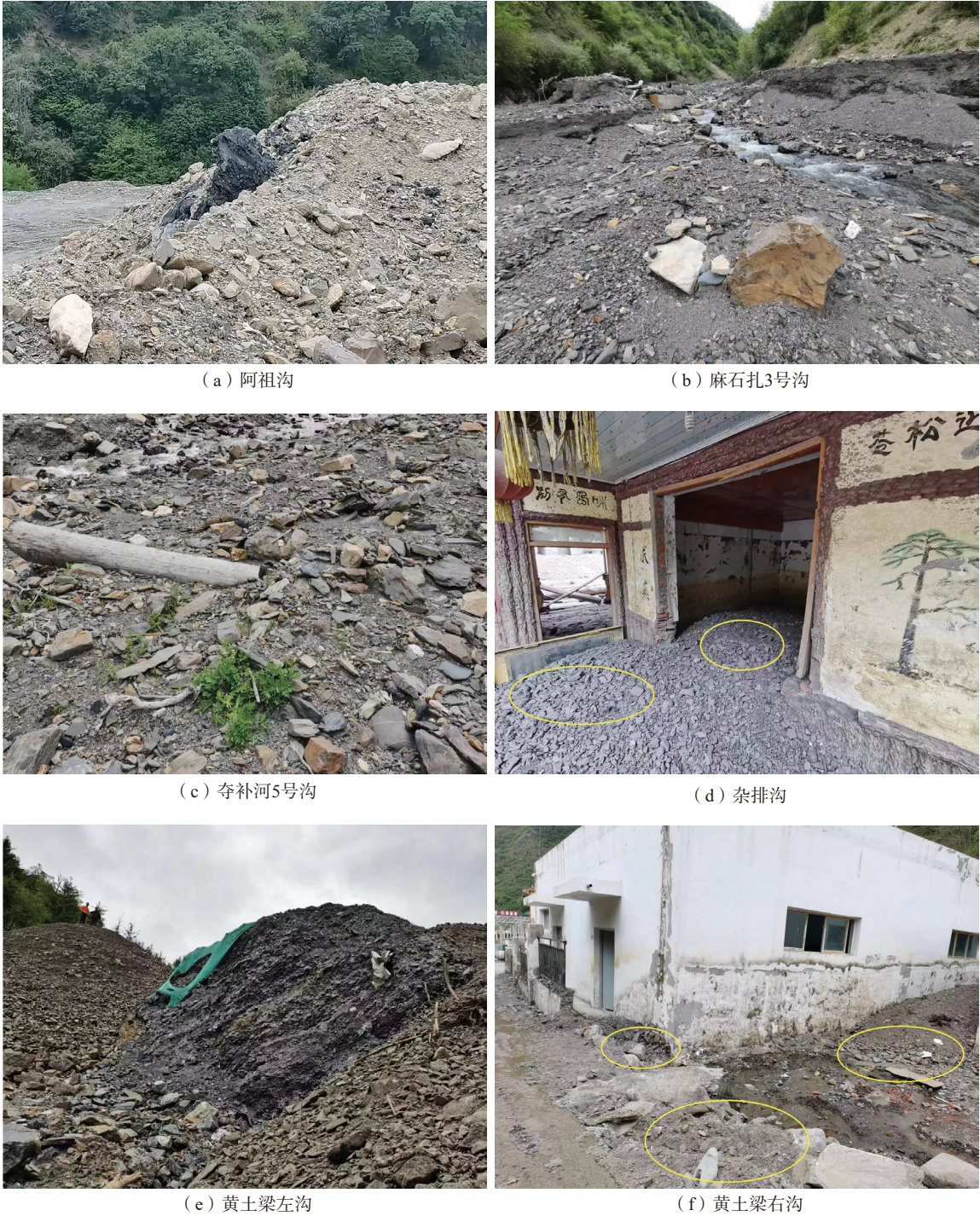
图 6 研究区泥石流原状物颗粒组成
