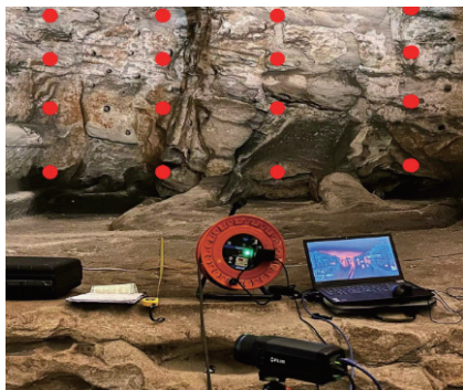
图 1 壁温测试与区域温度监测的外观情况
