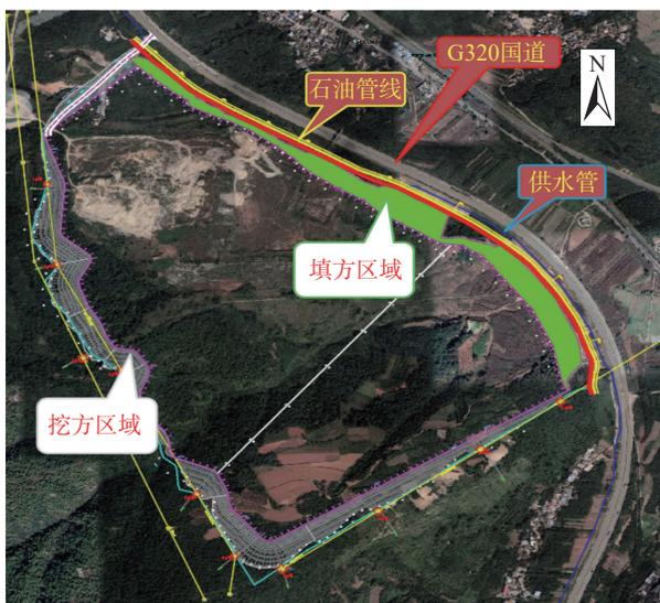
图1 填方边坡及油气管道位置关系图
