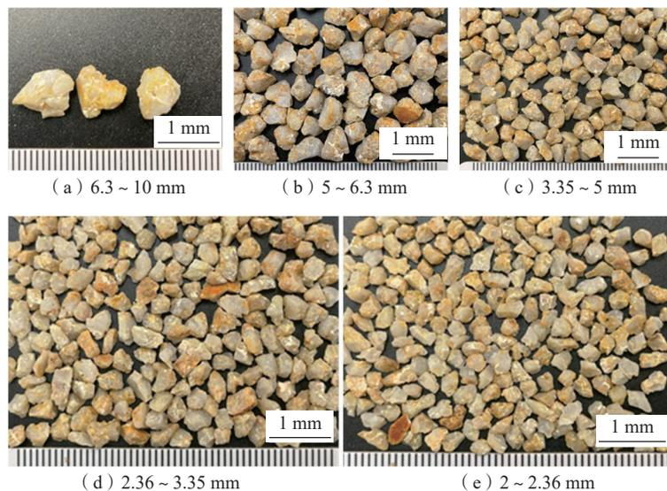
图 6 2#土样 5 组砾粒的立体显微镜图像
