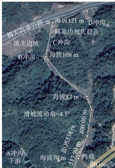
图 13 路基边坡失稳后滑坡沿 C 冲沟最大滑移距离和高程
