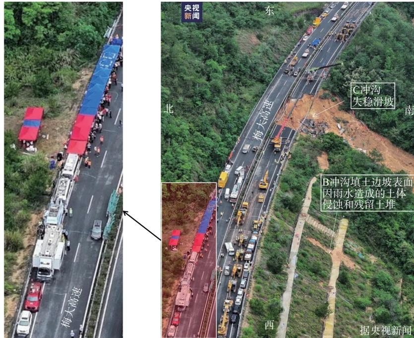
图 16 梅大高速公路路基边坡失稳滑坡段的公路与上方山坡之间存在洪水残留土石体
