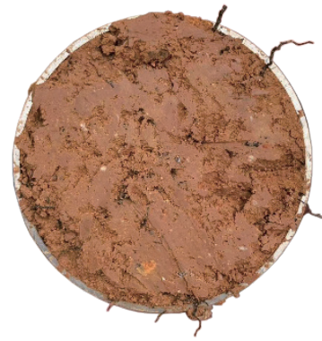
图2 环刀法获取未经削平的原状根系土样
